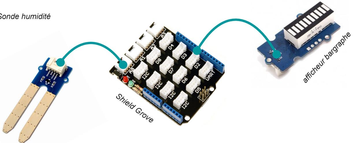
L' afficheur se connecte au PORT D2.
