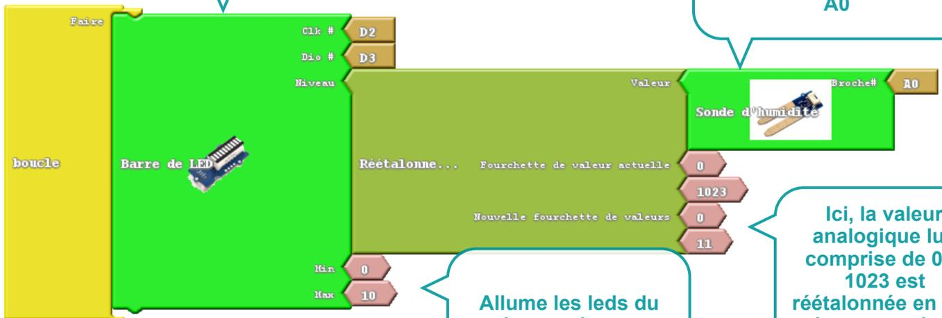
Allume les leds du bargraphe en fonction de la valeur réétalonnée
